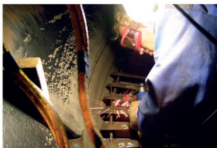
Процесс нанесения упрочняющего покрытия на лопатки турбины
