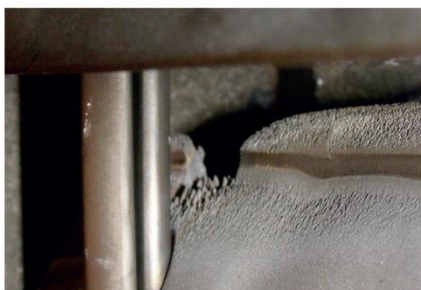
Разрушенная кромка лопатки
